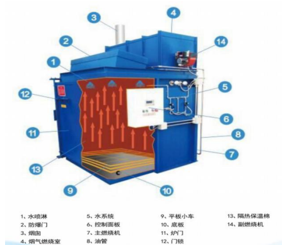
图 2-8 热洁炉内部构造图
