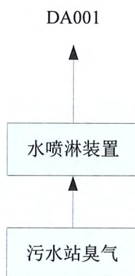
图 3-2 污水站臭气处理工艺简图
