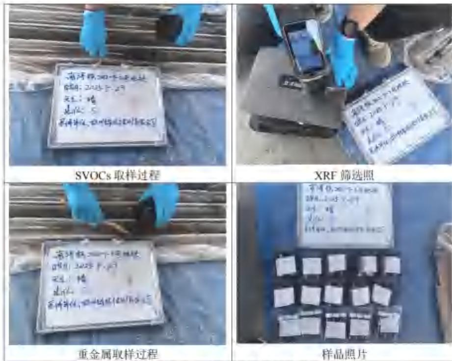
图 4 土壤现场取样及初筛照片
