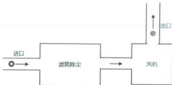
有组织废气 DA001、DA009 流程图：
