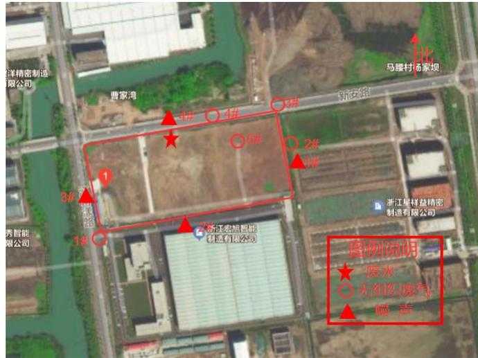
图3-4 废气排放监控点和厂界环境噪声测点布置图
