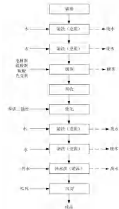
图4.5-1 挂镀铜自动线生产工艺流程图
