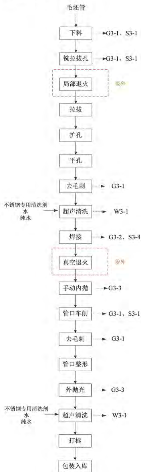
图 2-5 不锈钢洁净三通生产工艺流程和产污节点图
