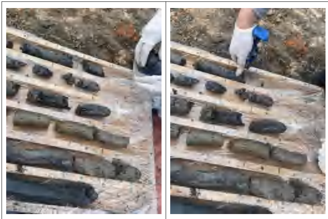
图 5.2-3 部分土壤采样照片
