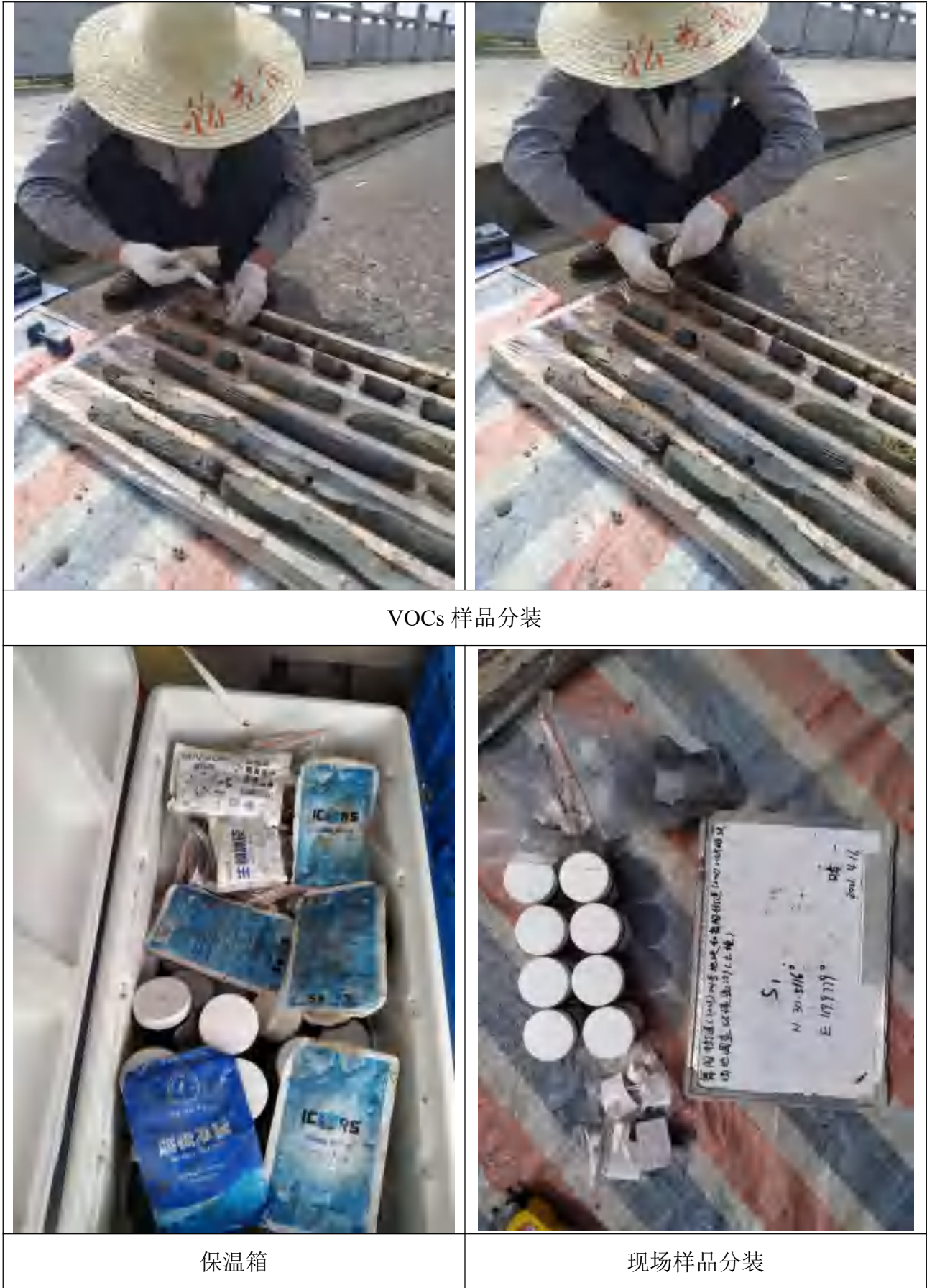
图 4 土壤取样现场照片
