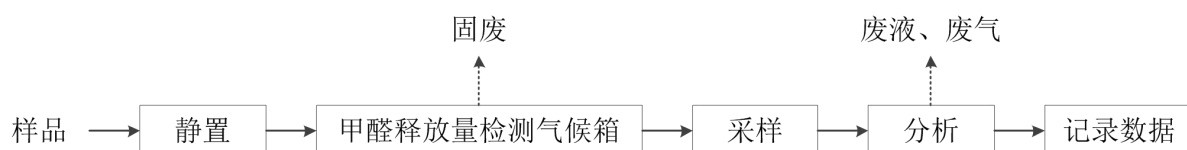
图 2-4 甲醛释放量检测流程和产污流程图
