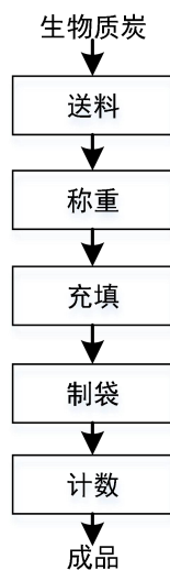
图 5-6 生物质炭包生产工艺流程及产污环节示意图
